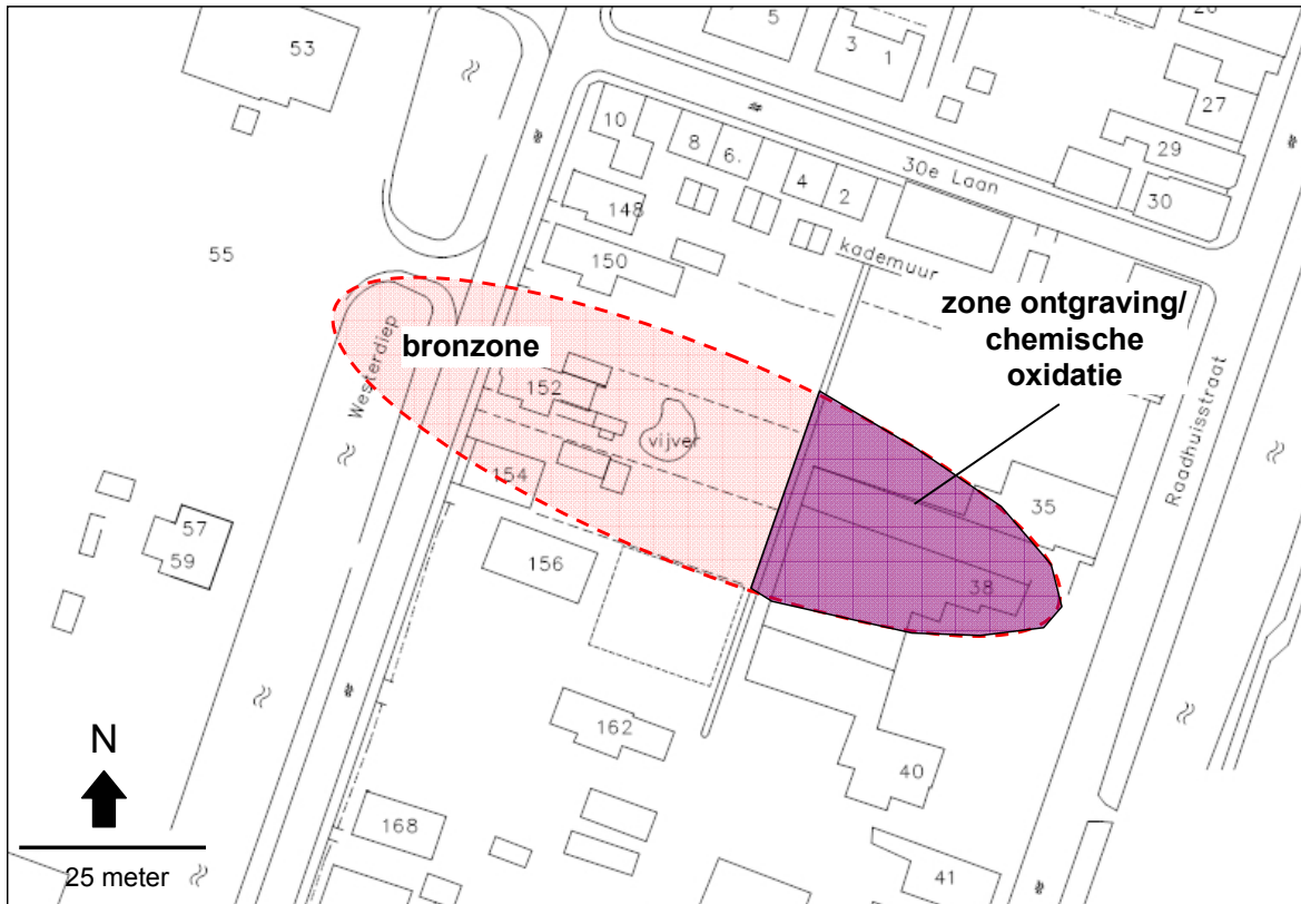
Figuur 5.1: Bovenaanzicht met een indicatie van het te ontgraven en vervolgens met chemische oxidatie te behandelen gedeelte van het bedrijfsterrein
