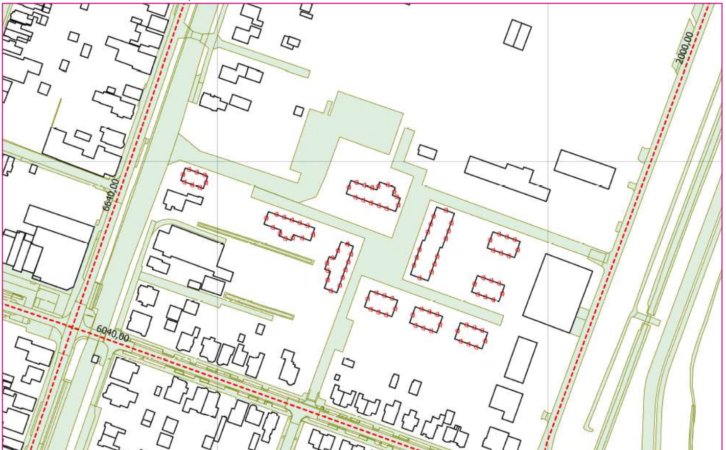
Figuur 4.1: overzicht van het akoestisch rekenmodel met de ligging van objecten, de harde bodemvlakken ( B_f = 0,0 ) en de toets-/rekenpunten
