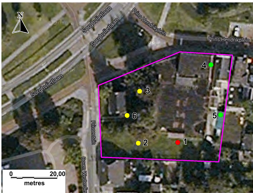
Figuur 7: Veendam, Prins Hendrikplein: boorpuntenkaart. Het plangebied is roze omlijnd. De genummerde punten zijn de locaties van de zes boringen. De rode punt geeft de boring aan waar een podzolprofiel is gezien. Hier is ook het stuk vuursteen (Figuur 8) gevonden. De gele punten geven boringen met een dunne laag beekleem tussen het veen en het dekzand aan. De groene boorpunten geven verstoring tot in de C-horizont aan. Het midden van het terrein was door dichte begroeiing met braamstruiken niet toegankelijk.
