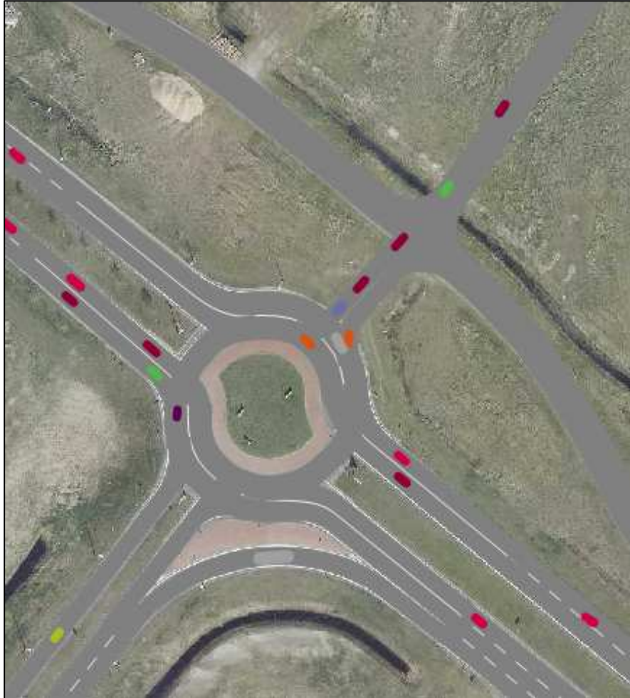
Figuur 5.2: Toekomstige vormgeving rotonde N366 - N33 (west) met 4 takken (1 rijstrook voor aankomend verkeer op de nieuwe kruispunttak)
