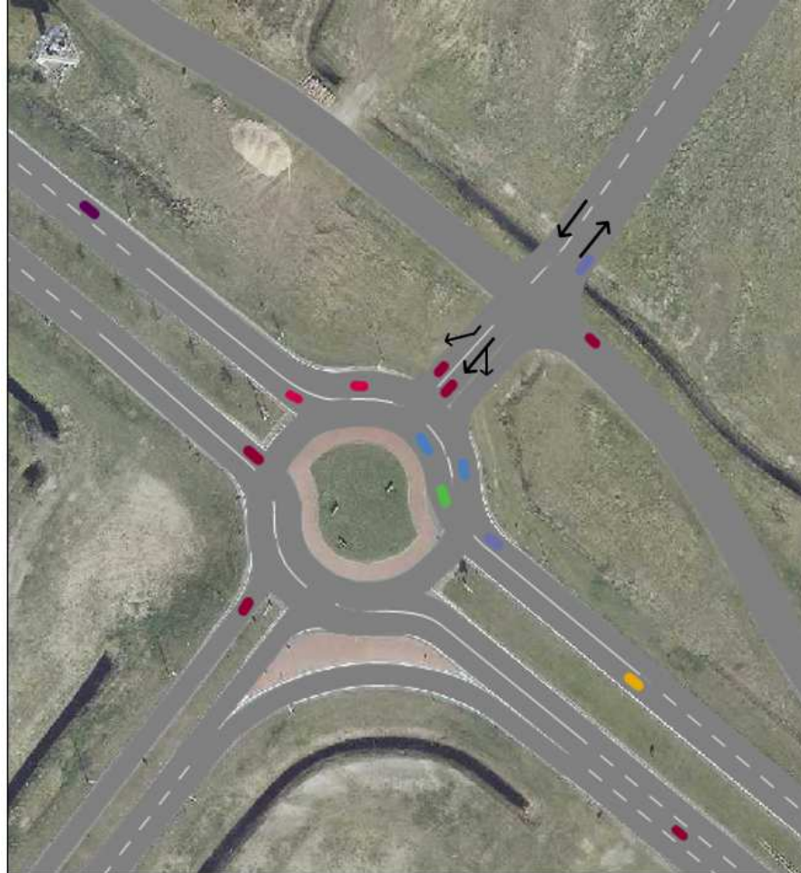
Figuur 5.3: Toekomstige vormgeving rotonde N366 – N33 (west) met 4 takken (2 rijstroken voor aankomend verkeer op de nieuwe kruispunttak)
