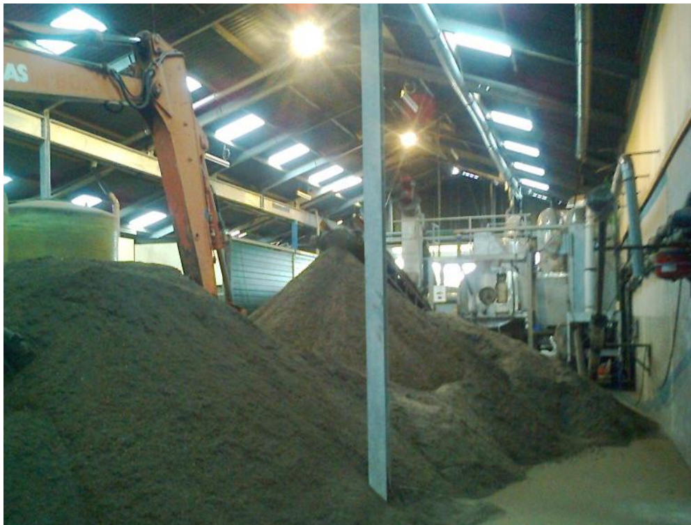
Afbeelding 2.6. Proceshal met droger en digestaat
