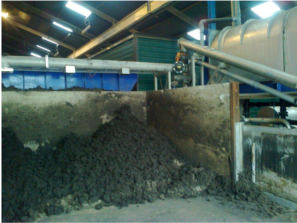
Afbeelding 2.5. Proceshal met schroefpers en droge fractie
