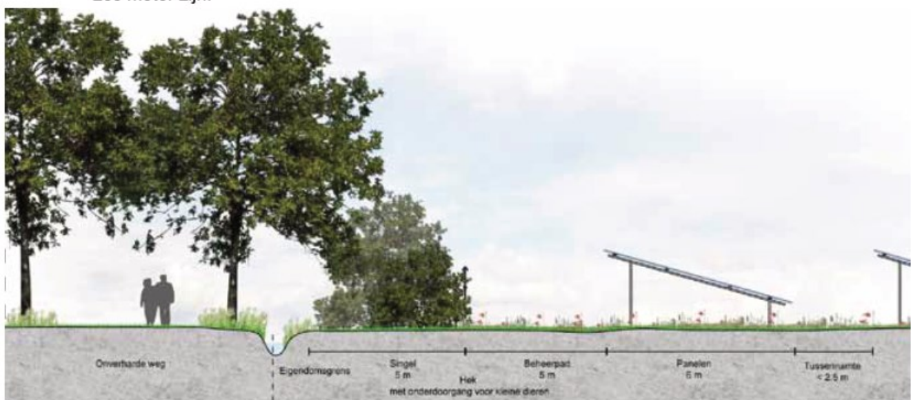
Afbeelding 25. Dwarsprofiel A-A' inpassing van de noordzijde.
