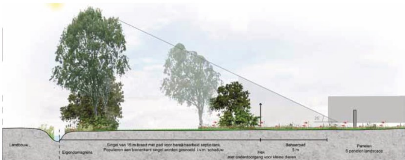
Afbeelding 26. Dwarsprofiel C-C' inpassing van een deel van de rand inclusief behoud enkele populieren tbv vliegrouwe voor vleermuizen.
