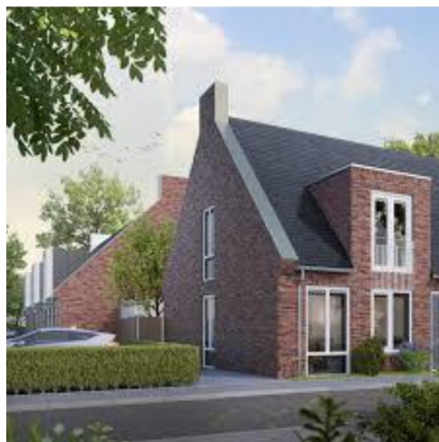
Beëindiging met tuitgevel en raampartij
