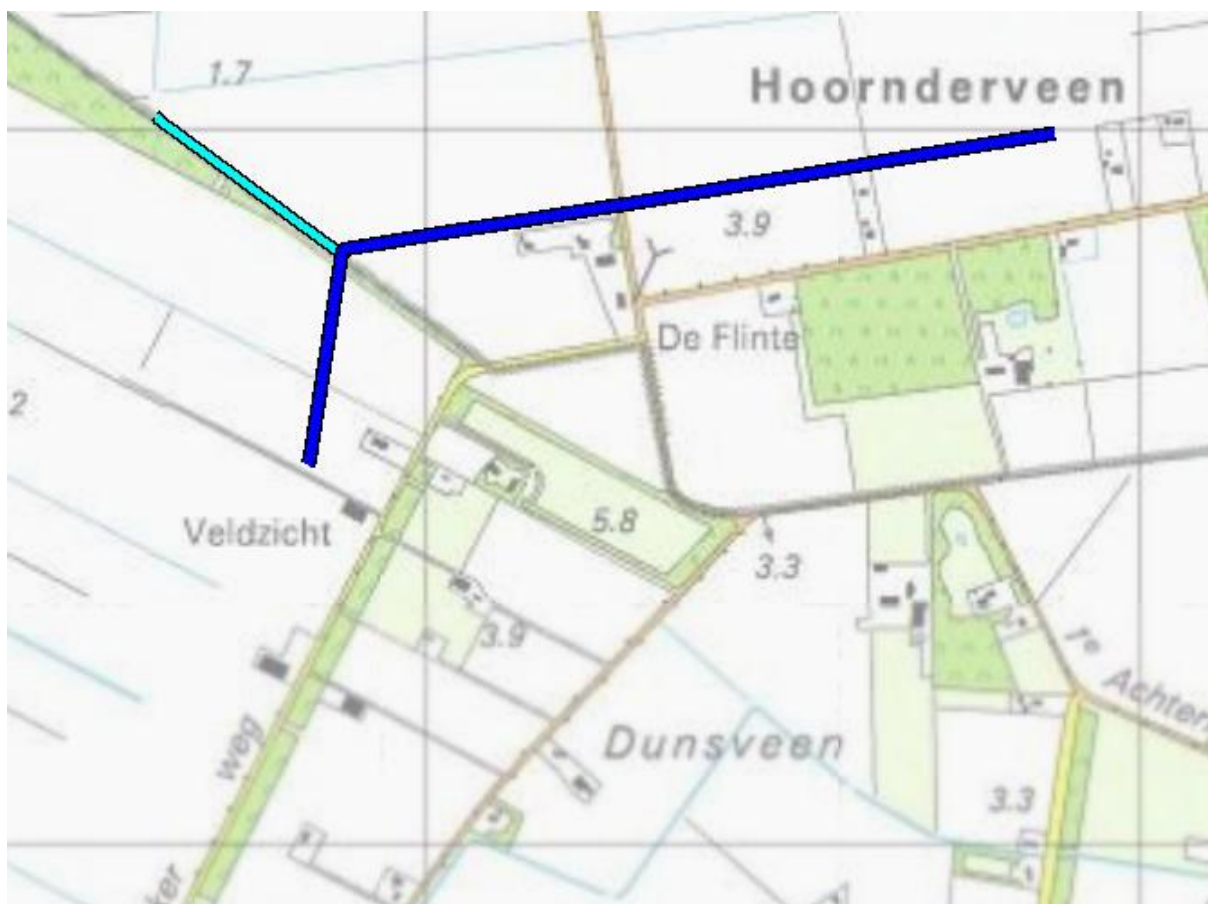
Figuur 1 Ligging van de leiding N-523-52 op een topografische kaart. De ligging van de leiding na verlegging is weergegeven in het donkerblauw; de ligging van de leiding voor verlegging is weergegeven in het lichtblauw.
