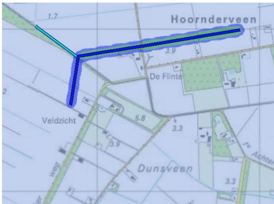
Figuur 3 Ligging van gastransportleiding N-523-52 (donkerblauw) in de toekomstige situatie. De contouren van het PR van 10^{-7} en 10^{-8} per jaar van de leiding worden respectievelijk weergegeven met groene en blauwe gebieden. Het plaatsgebonden risiconiveau van 10^{-6} per jaar wordt niet bereikt.
