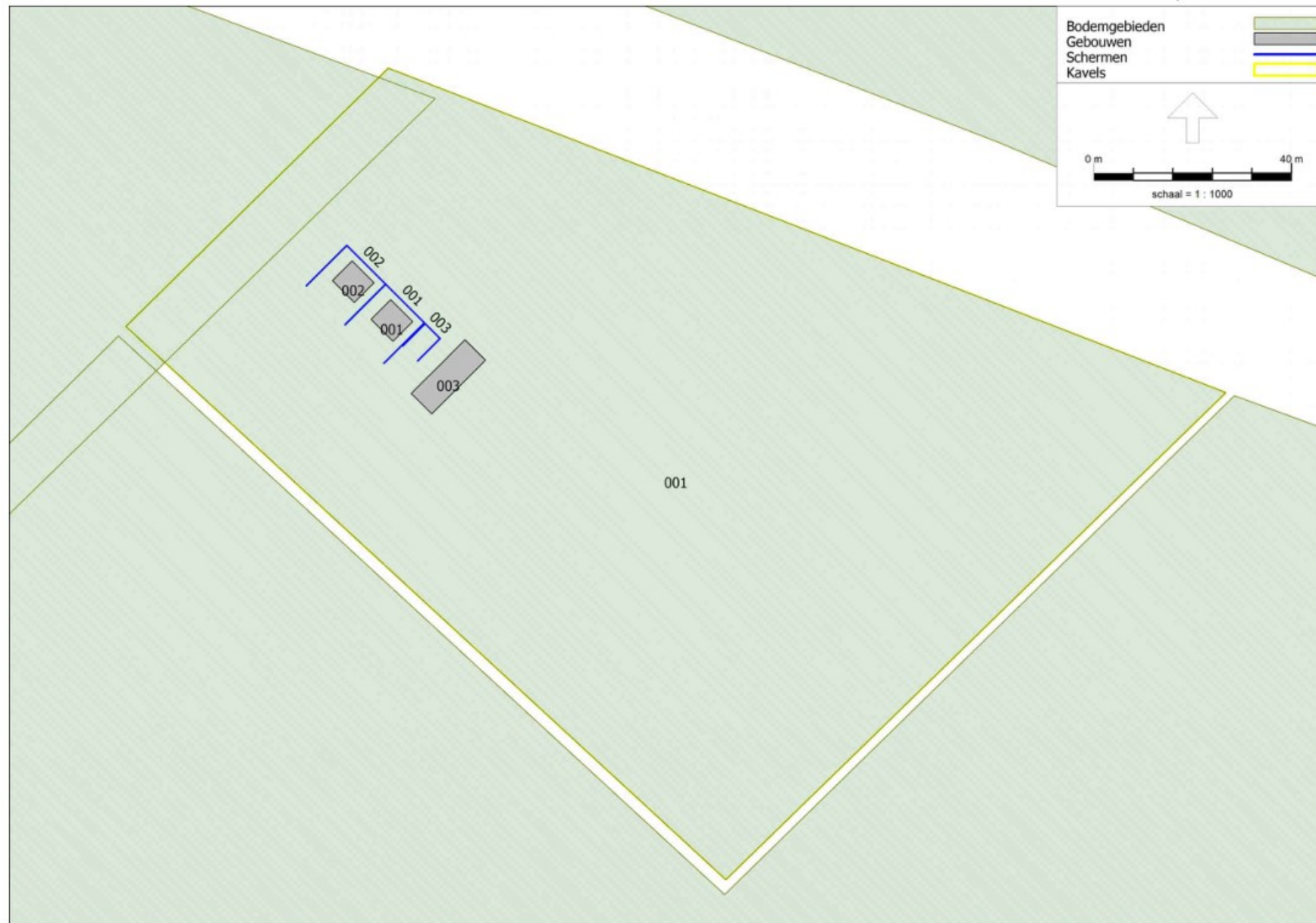
Figuur 1.2 Gebouwen en schermen op transformatorstation (detail trafostation)
