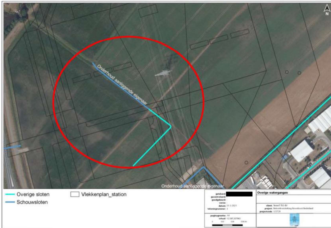
Afbeelding 4.3 Schouwslot en overige sloot ter demping
