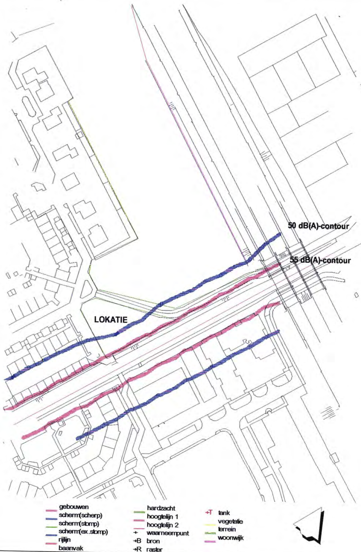
figuur 5: rekenmodel busbaan met de 50 dB(A) en 55 dB(A) contouren op b=4,5 m
