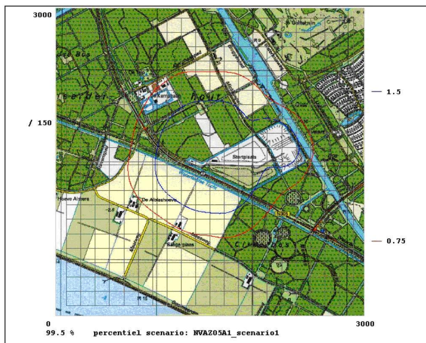
Figuur 5.1: Geurcontour van 0,75 en 1,5 ge/m 3 als 99,5-percentielwaarden als gevolg van stortplaats
