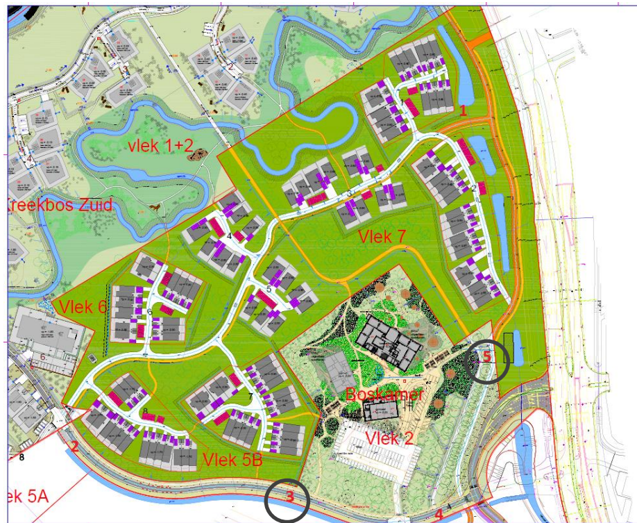
Figuur 2-2 Plan van het nieuw te ontwikkelen Muiderduin. Boskamer bevindt zich in het zuiden. Er zijn vijf aansluitingen van het greppelsysteem op de hoofdwaterstructuur (1-5) waarvan aansluitingen 3 en 5 van belang zijn voor de afwatering van Boskamer.
