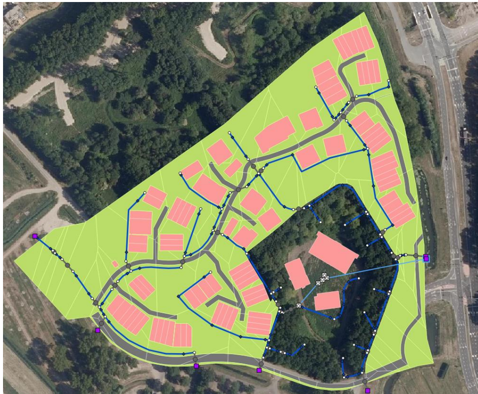
Figuur B1-4 Oppervlakken die via het NWRW model direct op de greppels zijn aangesloten
