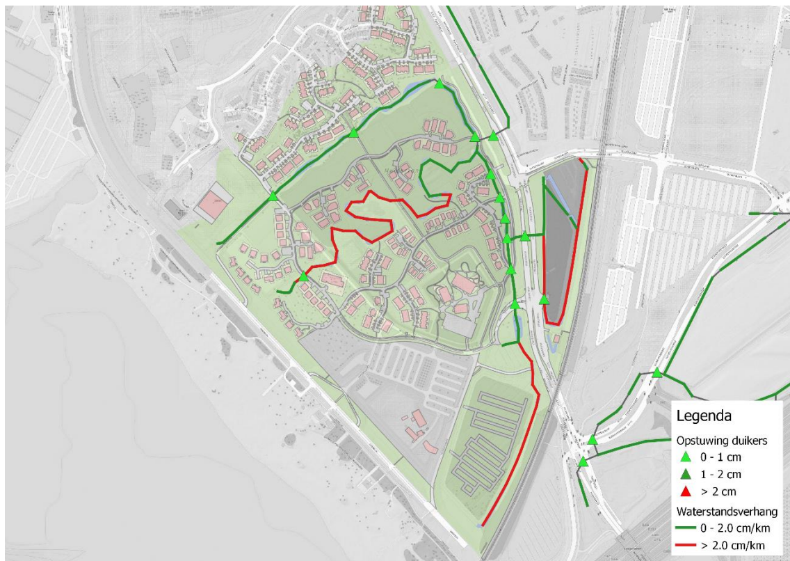
Figuur 5: Waterstandsverhang in watergangen en opstuwing over duikers bij een stationaire 13 mm/uur bui
