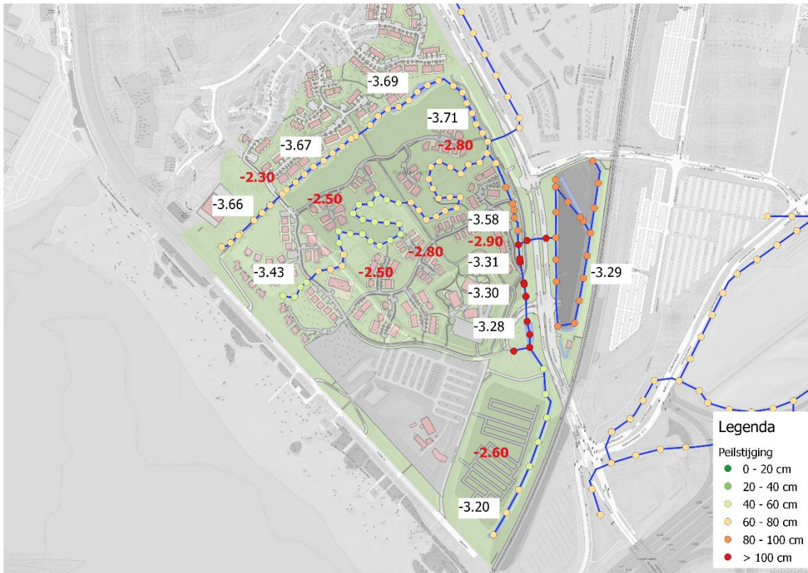
Figuur 9: Maximale peilstijging bij Bui667 (zonder vergrootte duikers). Getallen in een wit vak geven de maximaal berekende waterstand weer. Rode getallen geven de toekomstige wegashoogte weer.
