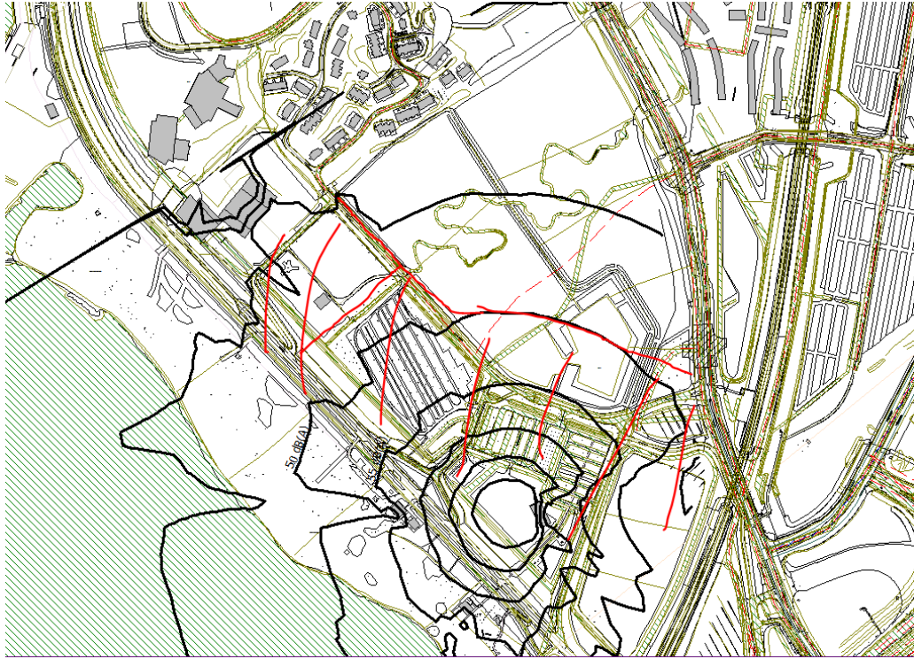
Figuur 2.1 Geluidscontouren openluchttheater Vis à Vis (zwart) en rood gearceerd deel waarbinnen geen woningen zijn toegestaan
