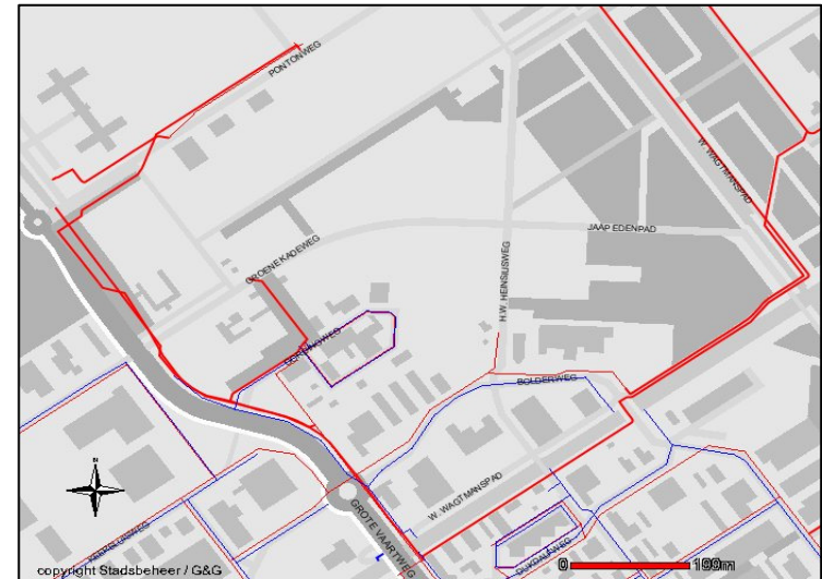
Figuur: riolering afvalwater (rood) en hemelwater (blauw)
