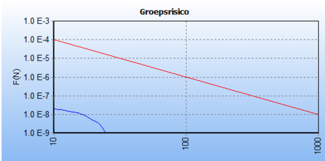
Figuur 5.1 FN curve voor 2985_leiding-N-533-20-deel-1 van N.V. Nederlandse Gasunie voor de kilometer tussen stationing 8310.00 en stationing 9310.00
