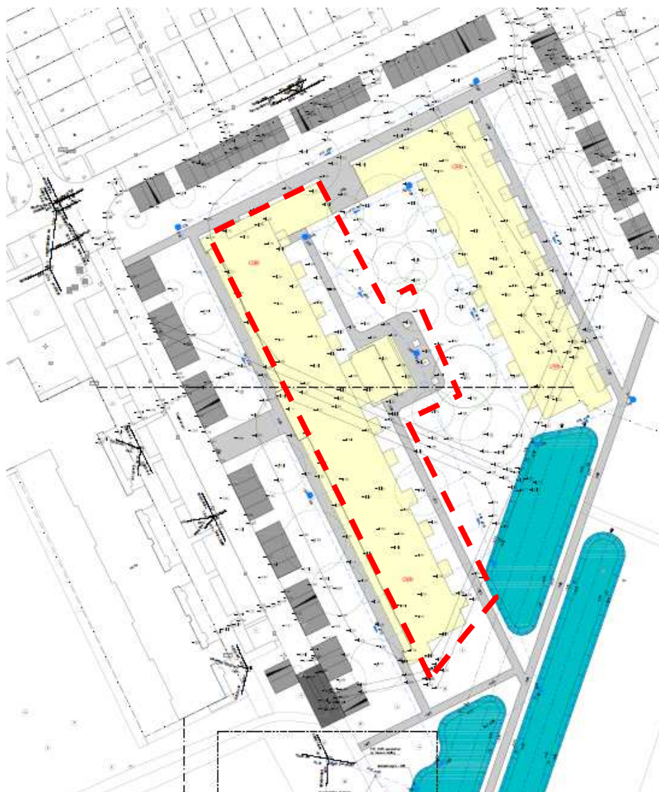
Figuur 1: Afvoerend oppervlak op maatgevende streng
