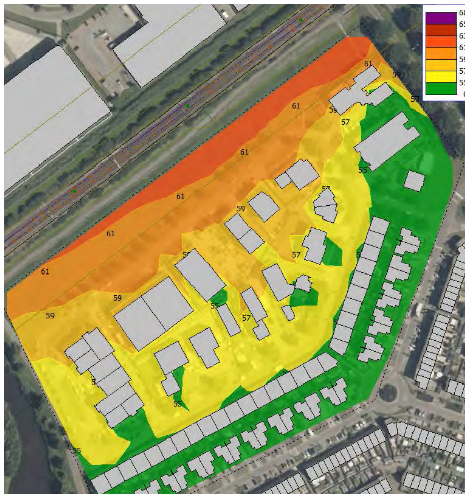
Figuur 4.2: geluidcontouren railverkeerslawaai Flevolijn, waarneemhoogte 4,5 m
