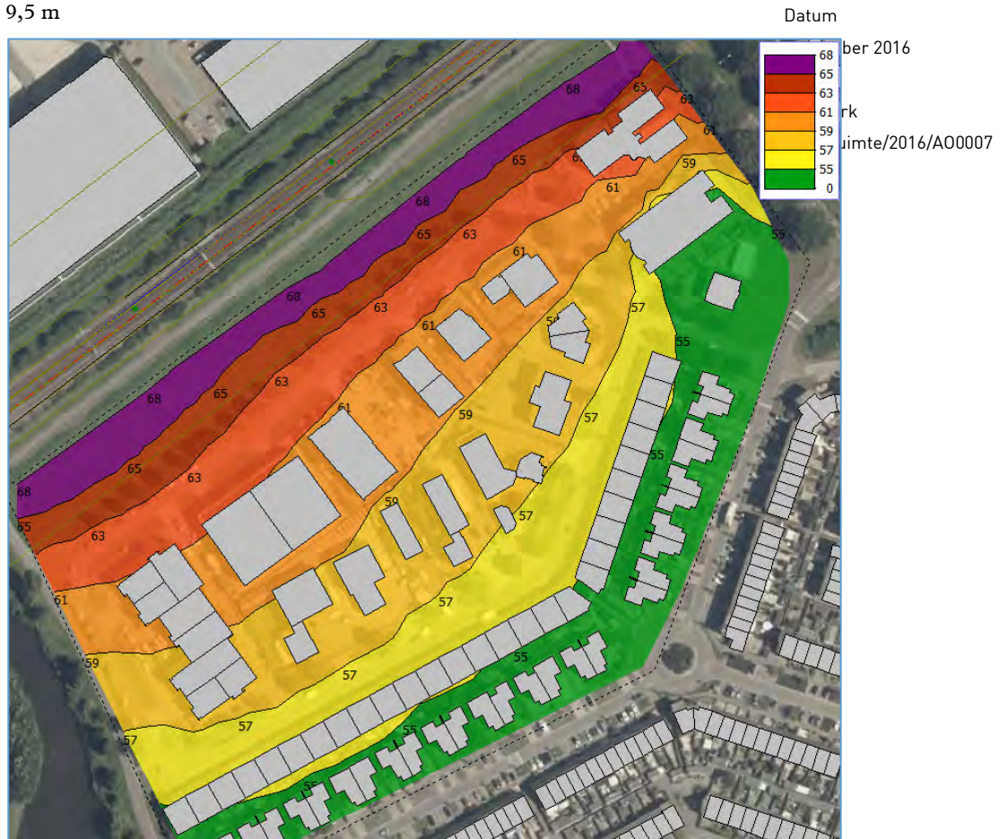
Figuur 4.3: geluidcontouren railverkeerslawai Flevolijn, waarneemhoogte 9,5 m
