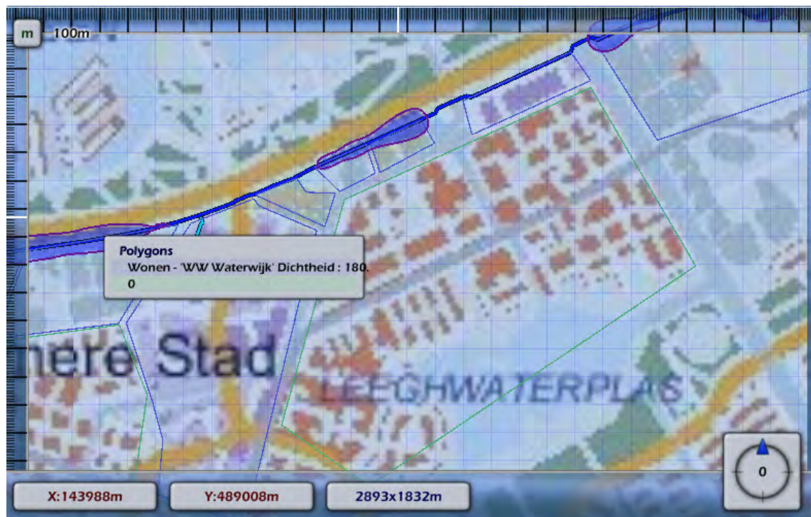
Figuur 3.2 Plaatsgebonden risico voor 1079_leiding-N-533-20-deel-1 van N.V. Nederlandse Gasunie
