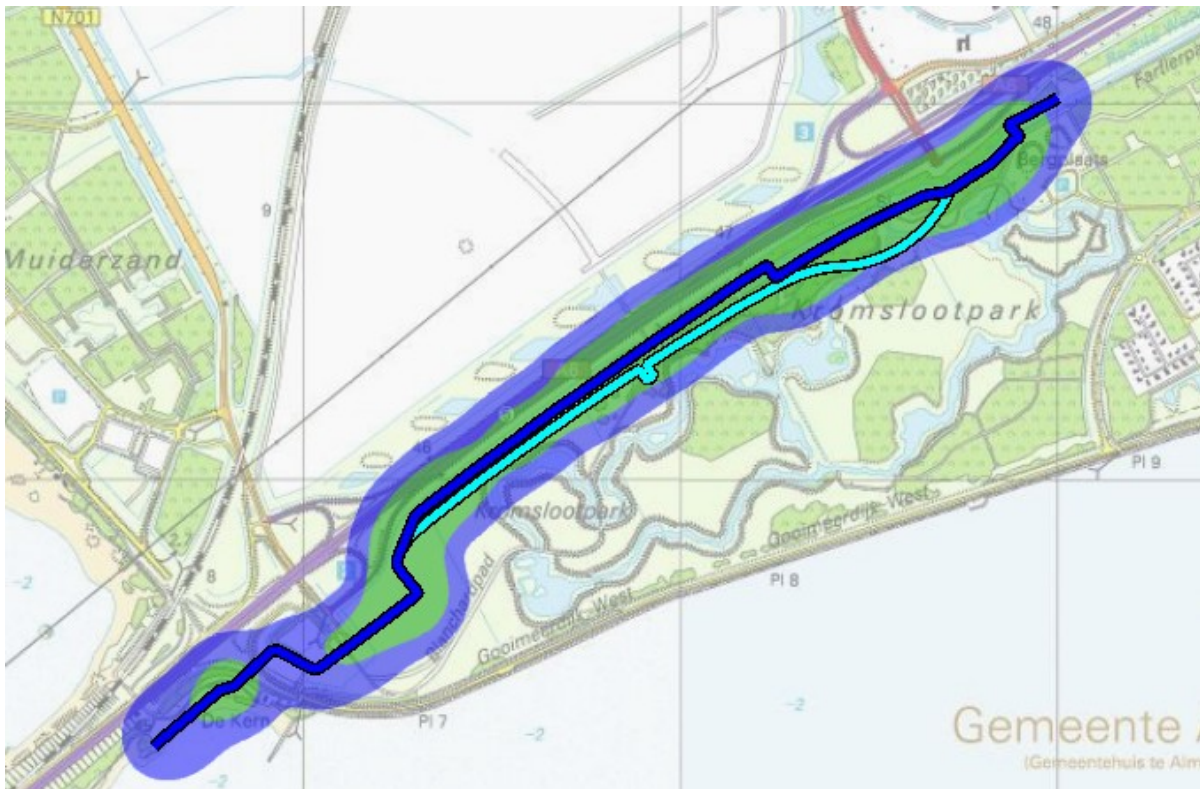
Figuur 4 Ligging van gastransportleiding W-533-19 (donkerblauw) in de huidige situatie. De contouren van het PR van 10^{-7} en 10^{-8} per jaar van de leiding worden respectievelijk weergegeven met groene en blauwe gebieden. De contouren van het PR van 10^{-6} per jaar zijn niet zichtbaar omdat het risiconiveau van 10^{-6} per jaar nergens wordt gehaald.
