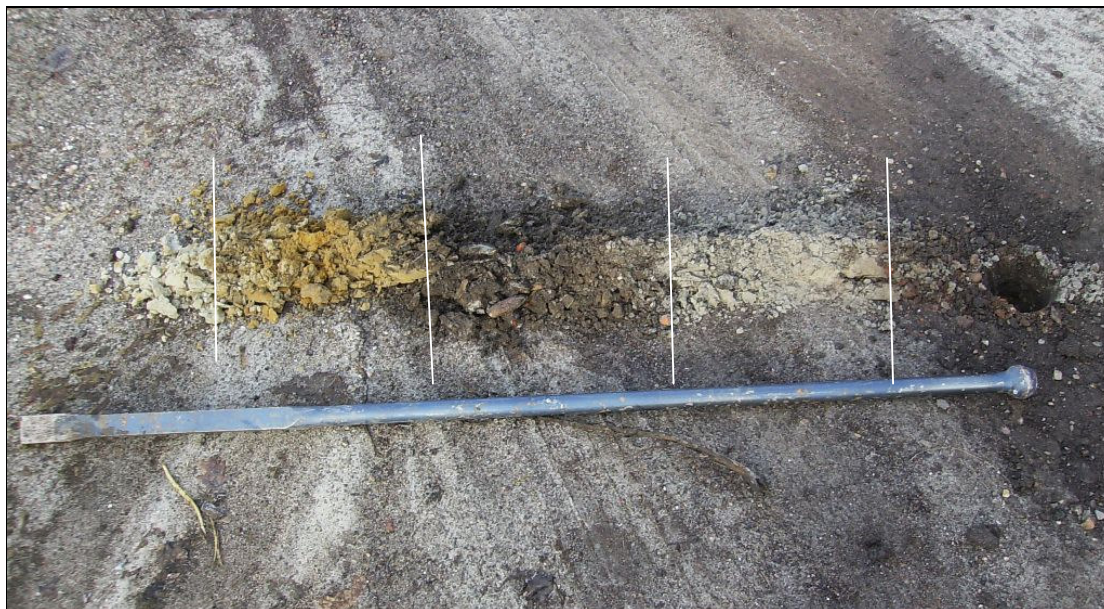
Afbeelding 3. Boring 1 met van rechts naar links puin, ophoogzand, vergraven grond, geel en witgrijs dekzand.
