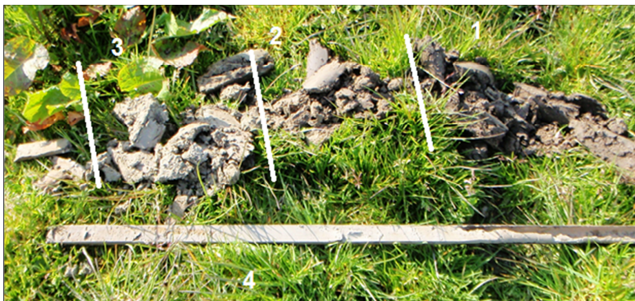
Afbeelding 3. Foto van boring 1 waarbij 1: bouwvoor, 2: sterk zandige klei, 3: uiterst zandige klei en 4: zeer fijn, uiterst siltig zand
