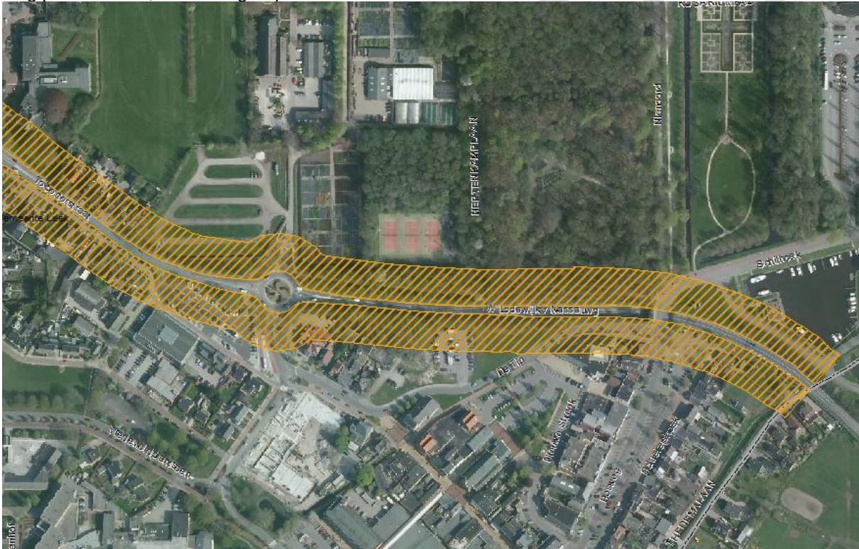
Figuur 4: 30 m zone met ruimtelijke beperkingen N372 ter hoogte van het plangebied
