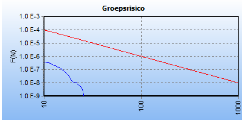
Figuur 11 fN curve voor 2039_leiding-N-507-33-deel-1 van N.V. Nederlandse Gasunie voor de kilometer tussen stationing 3820.00 en stationing 4820.00
