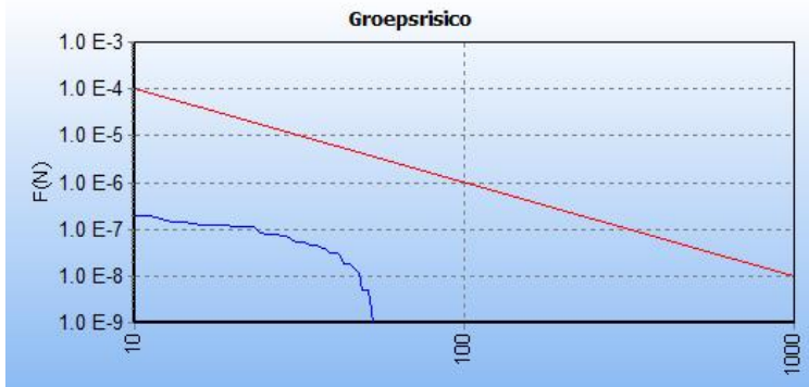
Figuur 18 FN-curve van de kilometer met de hoogste overschrijdingsfactor van gastransportleiding N-508-50 in de huidige situatie. De ligging van deze kilometer is hiernaast in het groen weergegeven op een topografische kaart.
