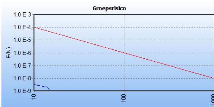
Figuur 20 FN-curve van de kilometer met de hoogste overschrijdingsfactor van gastransportleiding N-508-50 in de toekomstige situatie. De ligging van deze kilometer is hiernaast in het groen weergegeven op een topografische kaart.
