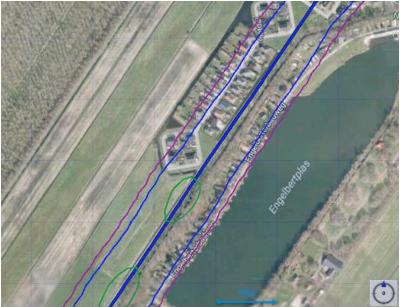
Figuur 14: Kritisch deel van de leiding N-508-50 in de huidige situatie, waar door in te zoomen wordt aangetoond dat er zich geen kritische objecten bevinden binnen de 10 -6 contour.
