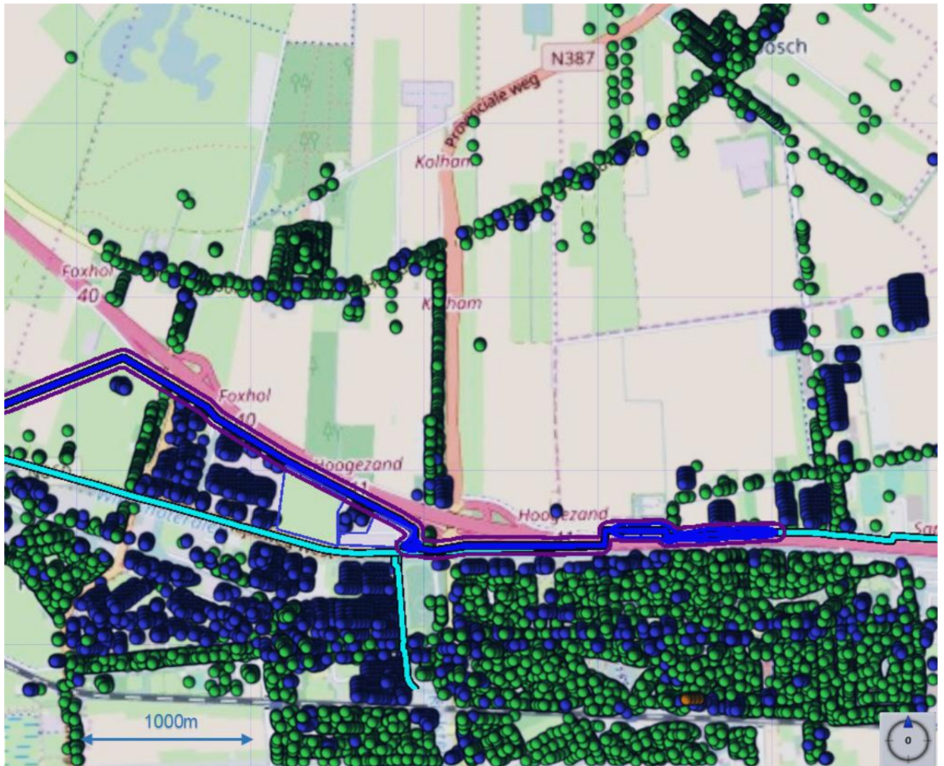
Figuur 15 Ligging van gastransportleiding N-508-50 (donkerblauw) in de toekomstige situatie. De plaatsgebonden risicocontouren rondom de leiding zijn, wanneer aanwezig, weergegeven met de volgende kleuren:
