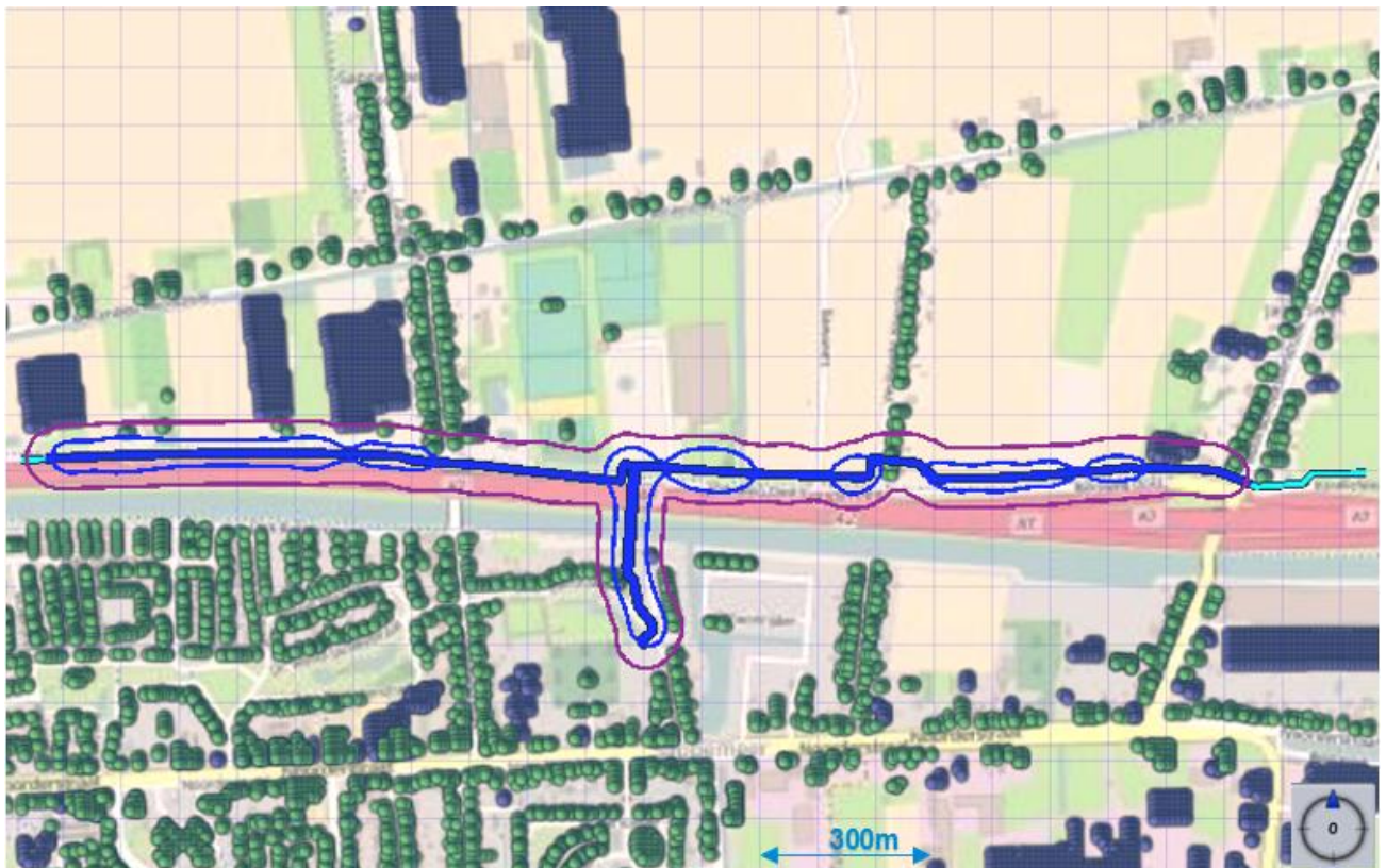
Figuur 4 Ligging van gastransportleiding N-508-50 (donkerblauw) in de toekomstige situatie. De plaatsgebonden risicocontouren rondom de leiding zijn, wanneer aanwezig, weergegeven met de volgende kleuren:
