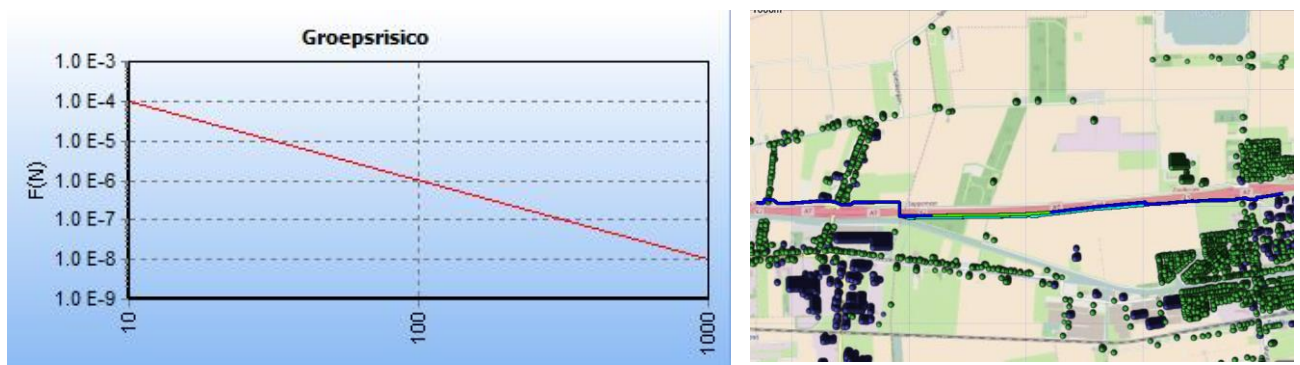
Figuur 6 FN-curve van de kilometer met de hoogste overschrijdingsfactor van gastransportleiding N-503-70 in de huidige situatie. De ligging van deze kilometer is hiernaast in het groen weergegeven op een topografische kaart.
