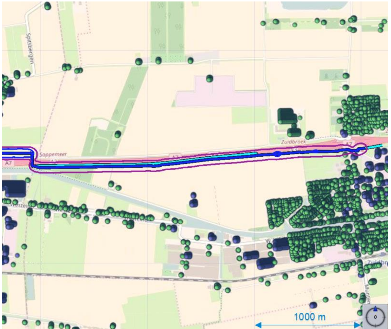
Figuur 4 Ligging van gastransportleiding N-503-70 (donkerblauw) in de toekomstige situatie. De plaatsgebonden risicocontouren rondom de leiding zijn, wanneer aanwezig, weergegeven met de volgende kleuren:
