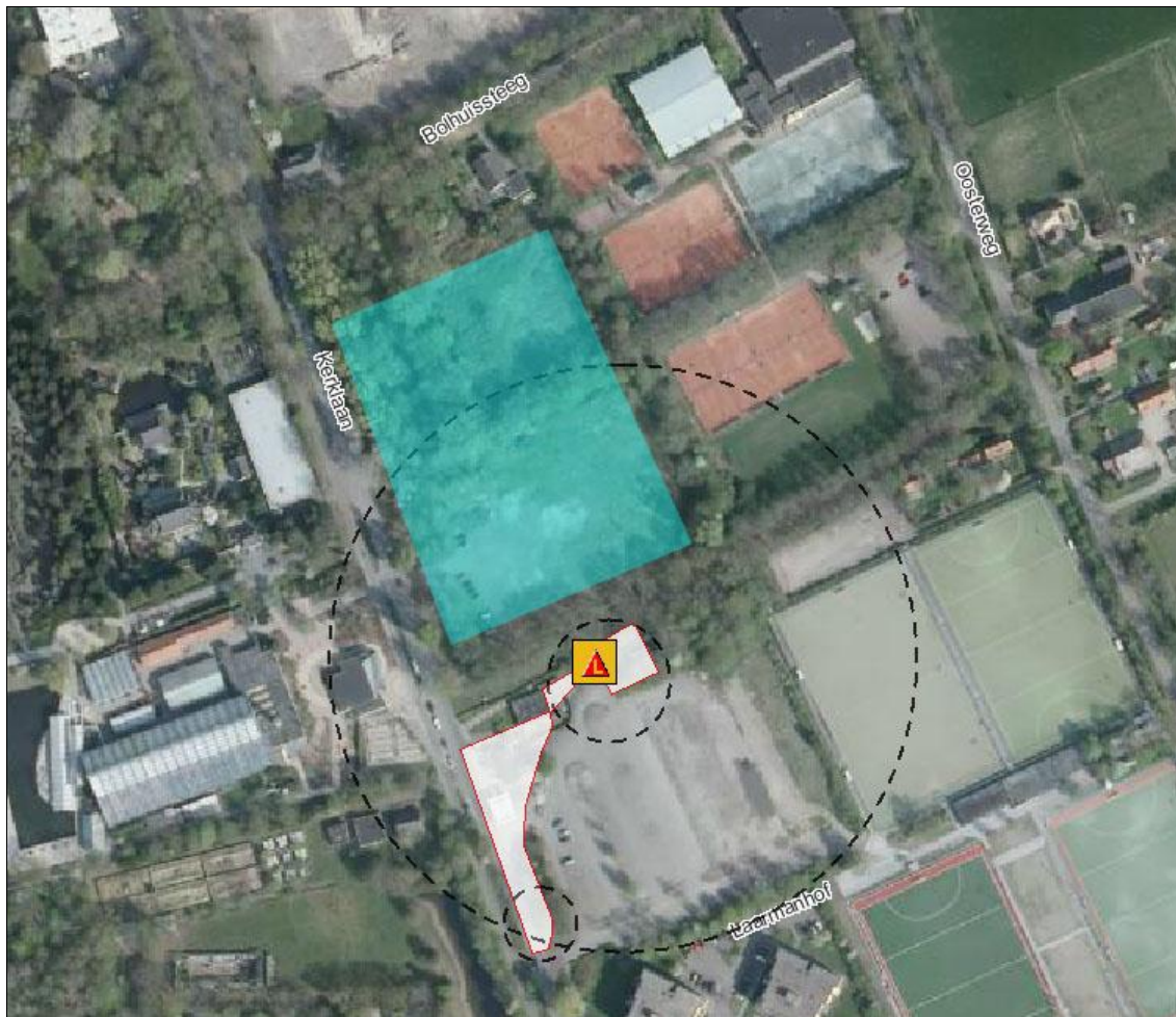
Plaatsgebonden risicocontouren lpg-tankstation
