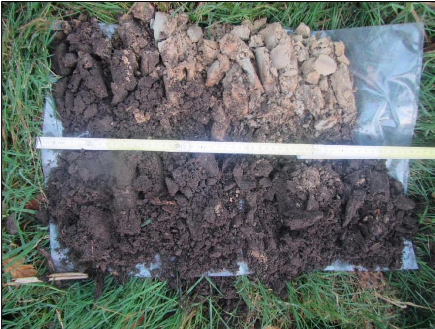
Afbeelding 3. Boring 2. De bodem is verstoord (omgewerkt) tot in de C-horizont (het lichtgekleurde zand), op circa 0,7 m-mv
