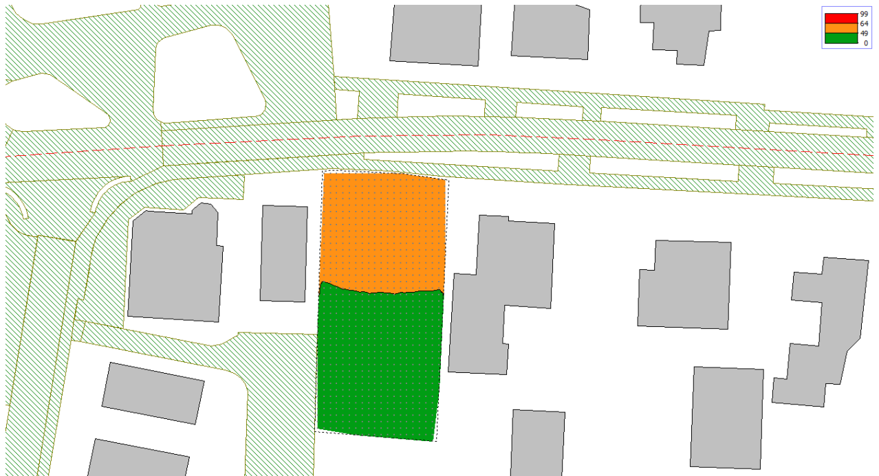
Figuur 4.4: Geluidbelasting locatie B als gevolg wegverkeer Provincialeweg N981 30 km/u (inclusief aftrek artikel 110g Wgh)
