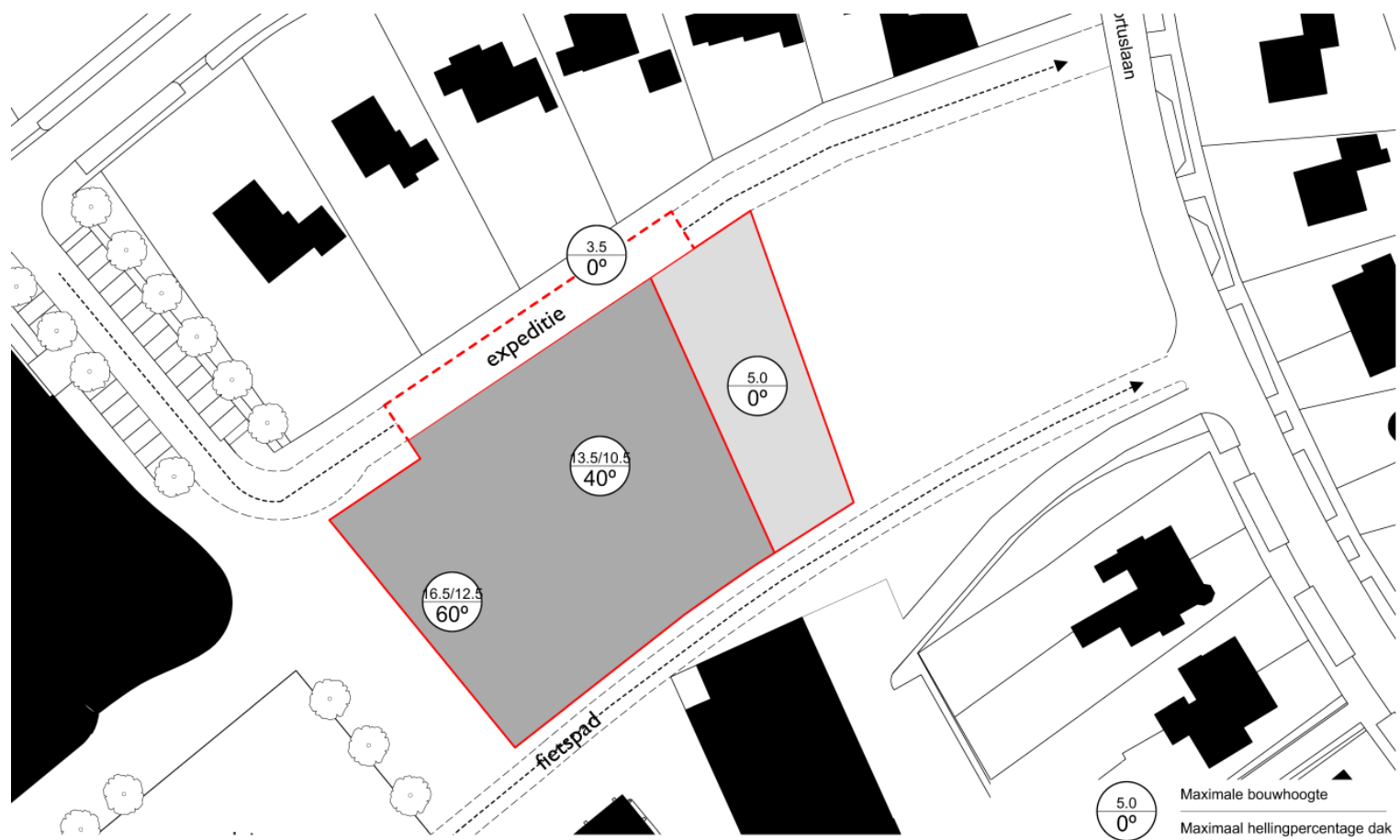
Figuur 3: Maximale bouwhoogte en maximale dakhelling
