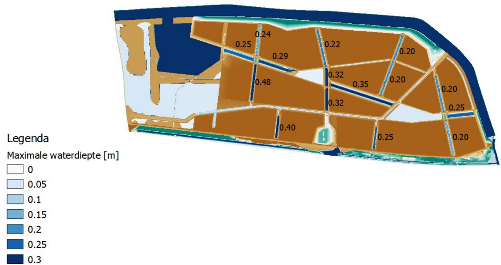
Figuur 3-1: Maximale waterdiepte bui T100. De waterdieptes in de wadi's zijn als getal (in meters) weergegeven.
