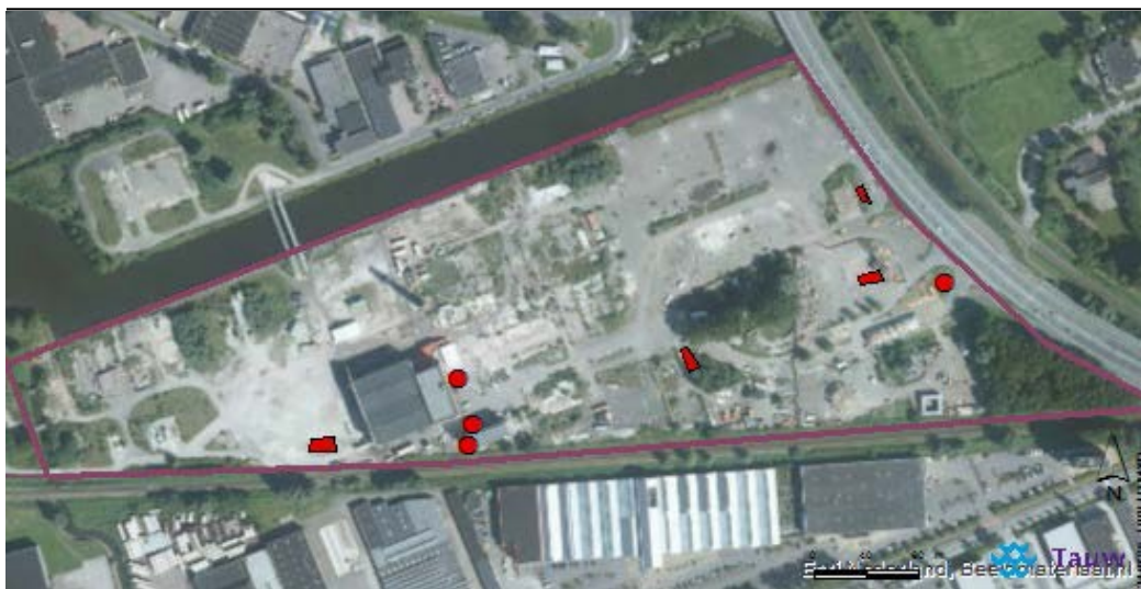
Figuur 4.6 Ligging tanks, oliewaterafscheider, trafo, tankplaats
