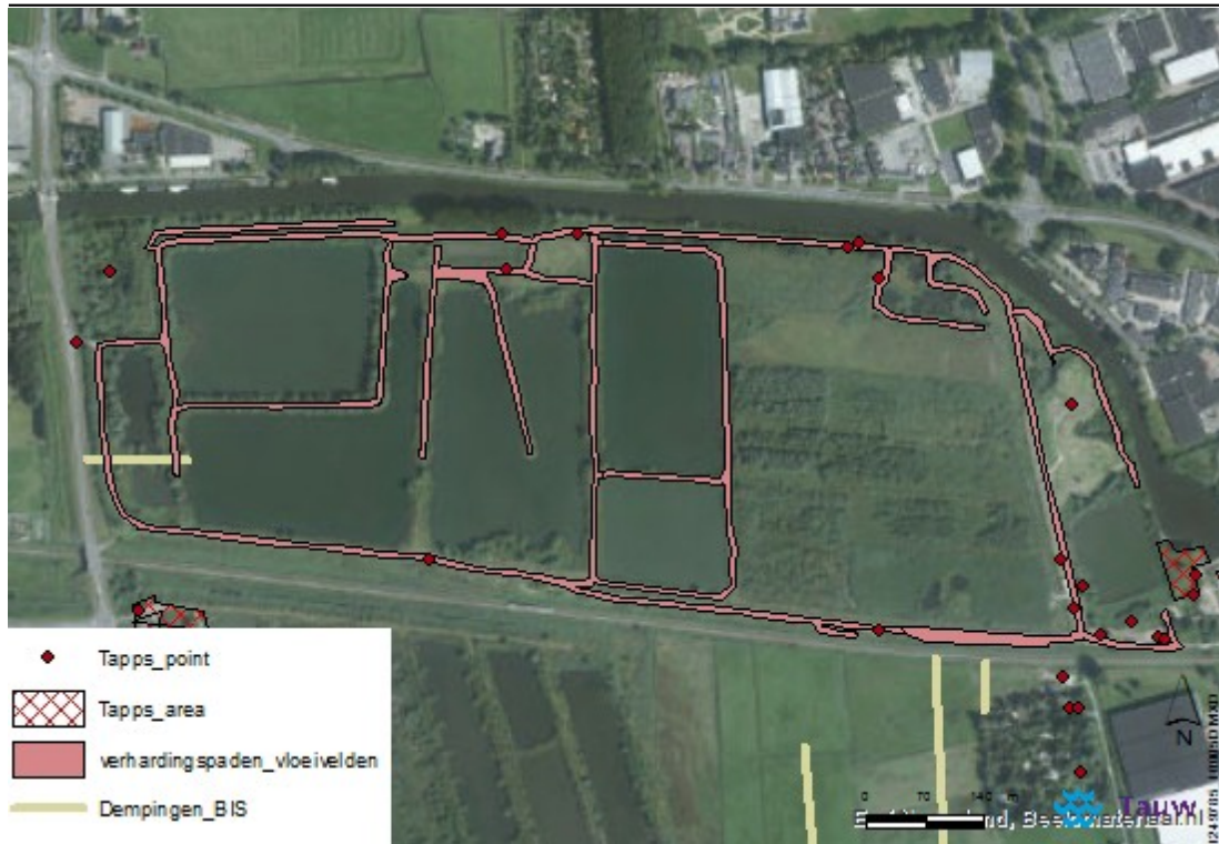
Figuur 4.10 Potentiële knelpunten ten aanzien van asbest op noordelijke vloeivelden (puinverharding, waarnemingen terreininspectie, dempingen)
