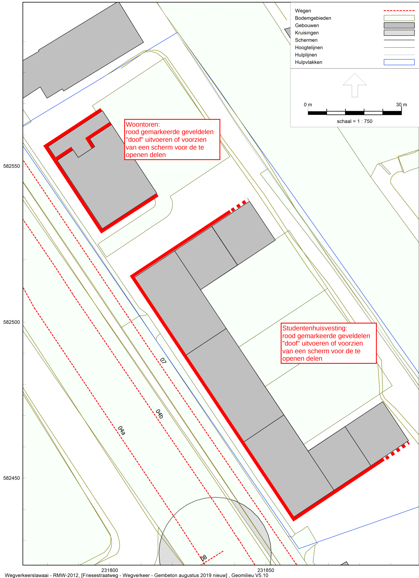
Overzicht van de gevels die "doof" moeten worden uitgevoerd of worden voorzien van een geluidscherm voor de te openen delen
