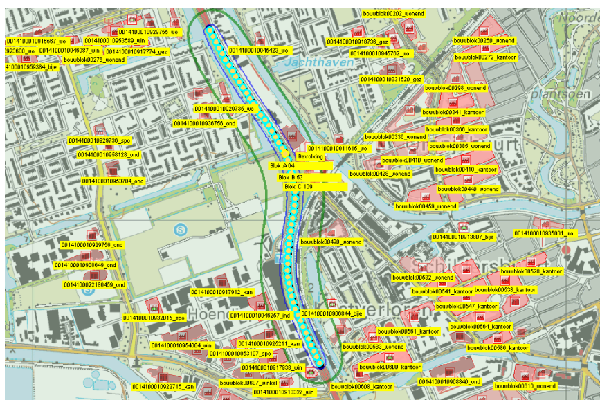
Figuur 5: Overzicht invoer RBMI en inzicht in plaatsgebonden risico 10^{-8} in het groen
