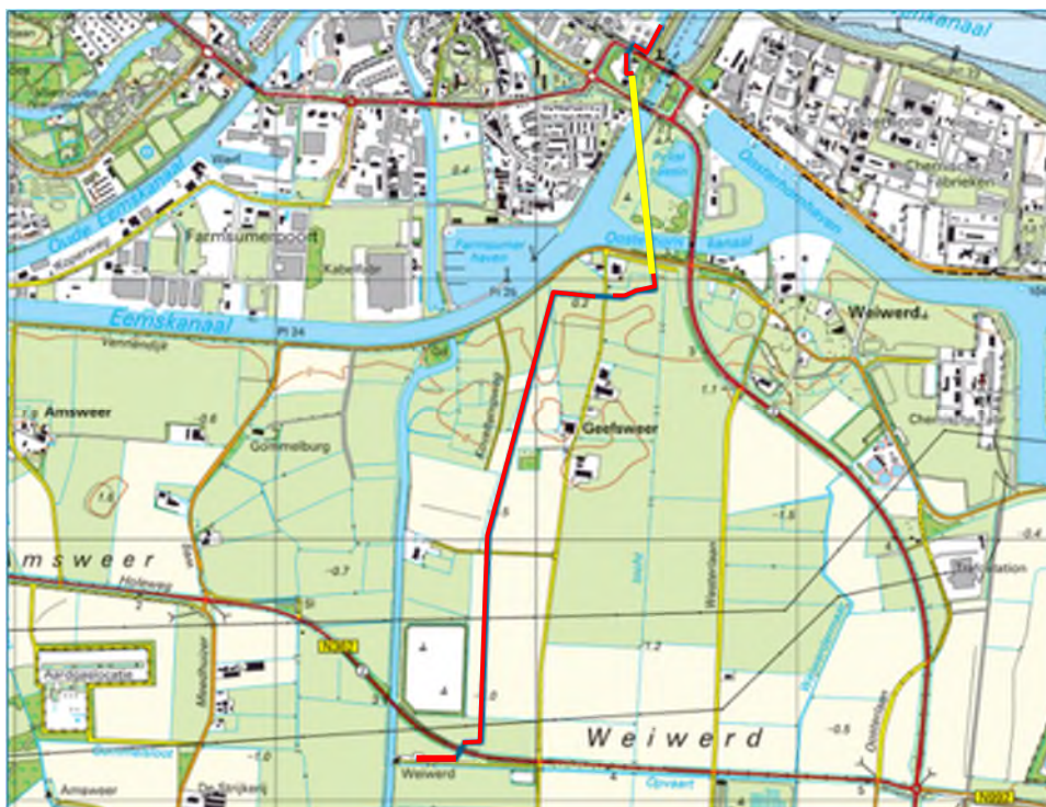
Afbeelding 3.14. Tracé in open ontgraving (rood) , HDD (geel) en boring onder weg (blauw) (topografische kaart).
