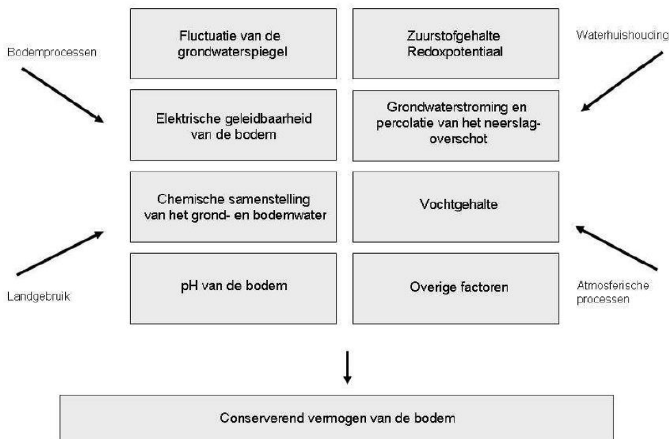
Afbeelding 14. Schematisch overzicht van de samenhang tussen de processen die het conserverend vermogen van de bodem bepalen. Fluctuatie van de grondwaterspiegel, grondwaterstroming en percolatie van het neerslagoverschot spelen hierin een centrale rol (uit Berg van den & Hatzmann 2005).
