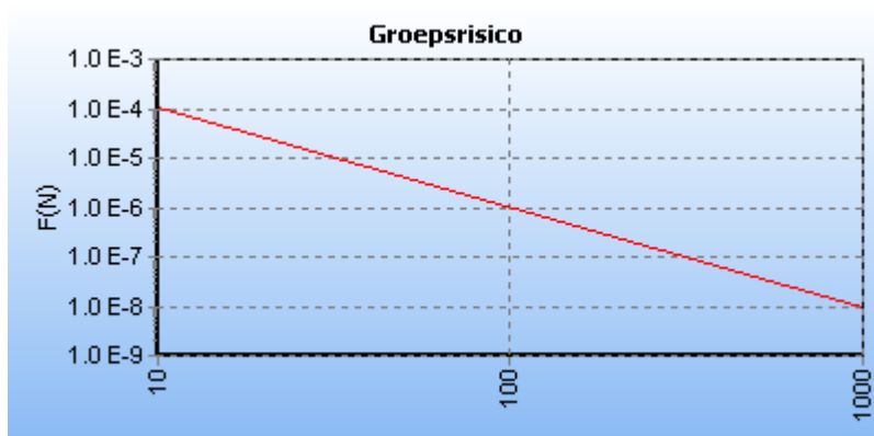
5.8 Figuur 5.8 FN curve voor N-509-39 van N.V. Nederlandse Gasunie voor de kilometer tussen stationing 0.00 en stationing 0.00
