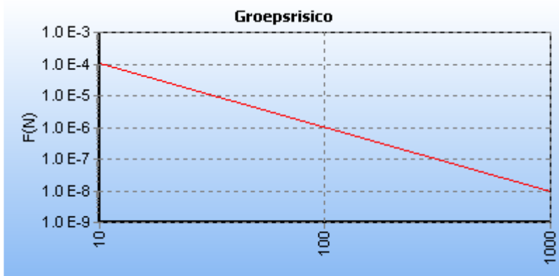
5.15 Figuur 5.15 FN curve voor N-509-92 van N.V. Nederlandse Gasunie voor de kilometer tussen stationing 0.00 en stationing 320.00
