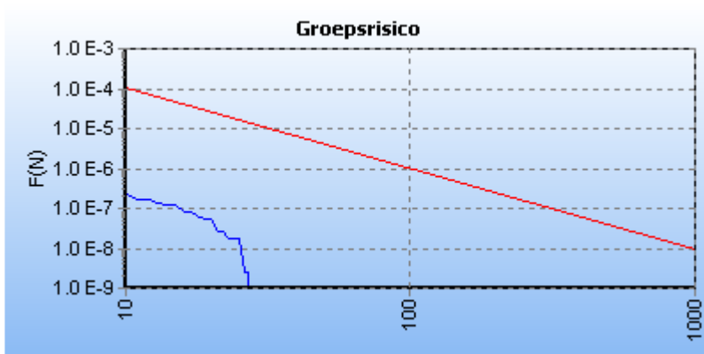
5.14 Figuur 5.14 FN curve voor N-509-90 van N.V. Nederlandse Gasunie voor de kilometer tussen stationing 18340.00 en stationing 19340.00
