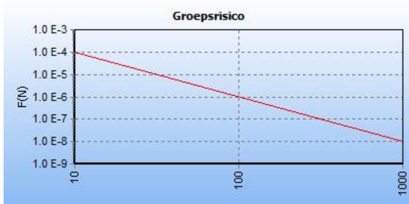
5.19 Figuur 5.19 FN curve voor 1744_leiding-N-509-96-deel-1 van N.V. Nederlandse Gasunie voor de kilometer tussen stationing 0.00 en stationing 1000.00
