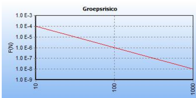
5.14 Figuur 5.14 FN curve voor 1744_leiding-N-509-84-deel-1 van N.V. Nederlandse Gasunie voor de kilometer tussen stationing 0.00 en stationing 60.00
