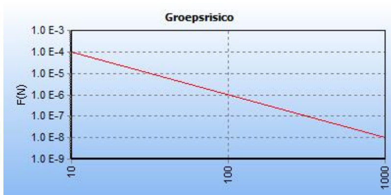
5.20 Figuur 5.20 FN curve voor 1744_leiding-N-509-98-deel-1 van N.V. Nederlandse Gasunie voor de kilometer tussen stationing 0.00 en stationing 50.00
