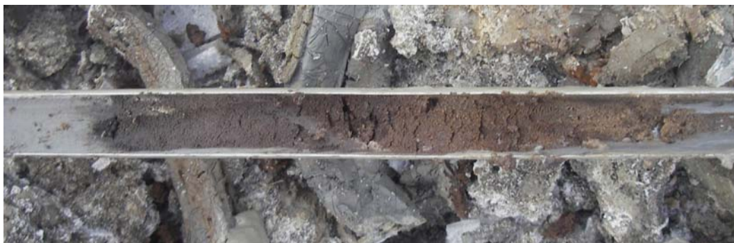
Figuur 6: Meedhuizen, Meedhuizerweg 18: Foto van het in boring 3 aangeboorde dekzand met geheel links de wadafzettingen die direct op de vernatte top van het dekzand liggen (links van het midden) en rechts het geoxideerde zand van de B/BC-horizont.
