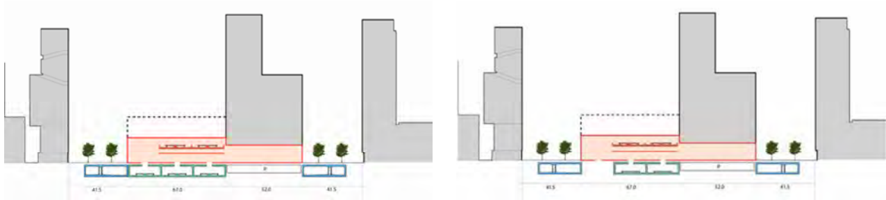
Figuur 0.13 Schematische weergave van alternatief 2 (links: 6 treinsporen en rechts: 4 treinsporen)
