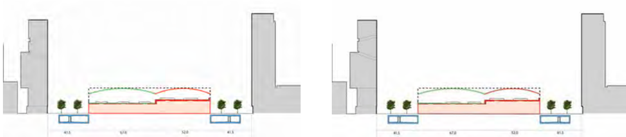
Figuur 0.15 Schematische weergave van alternatief 3 (links: 6 treinsporen en rechts: 4 treinsporen)
