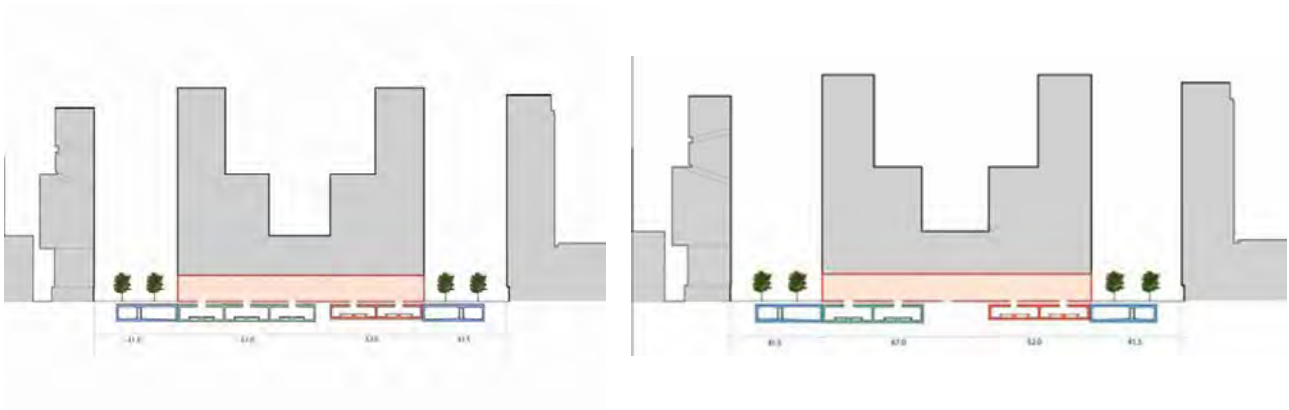
Figuur 0.11 Schematische weergave van alternatief 1 (links: 6 sporen en rechts: 4 sporen)
