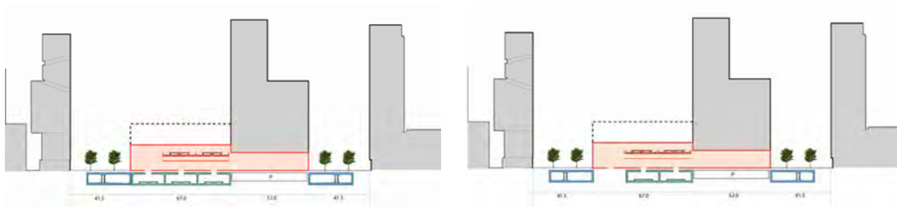
figuur 3.17 Schematische weergave van alternatief 2 (links: 6 sporen en rechts: 4 sporen)
