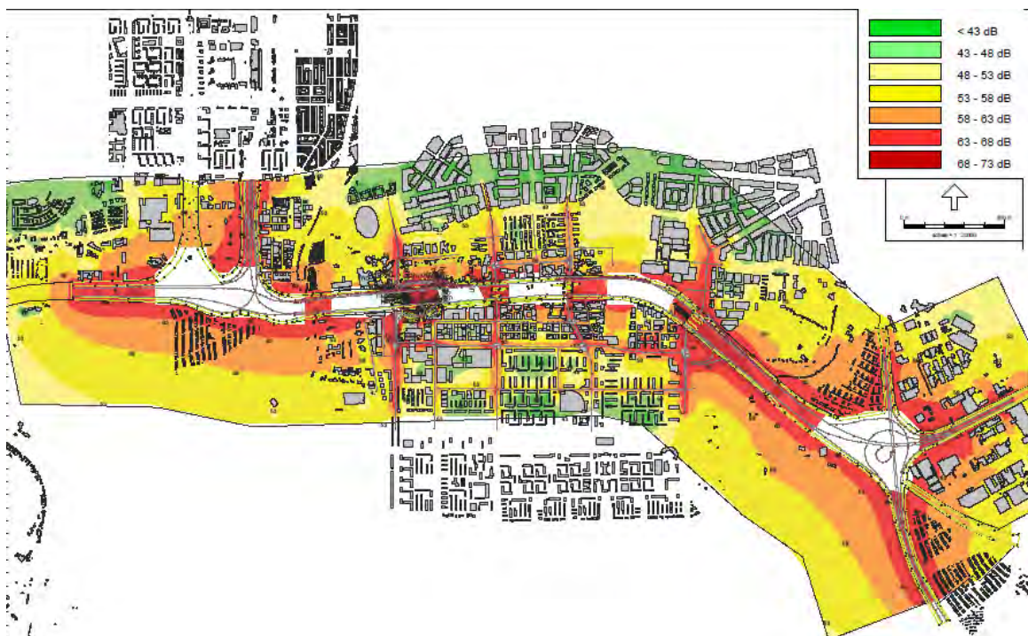
figuur 10.7 Geluidcontouren alle wegverkeer gecumuleerd (referentie 2020)
