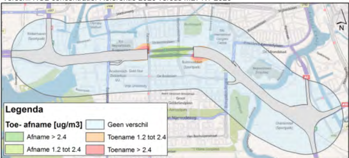
figuur 9.6 Vershilkaart concentraties NO 2 tussen de referentiesituatie 2020 en de MLT (boven lange tunnel, onder korte tunnelvariant)
