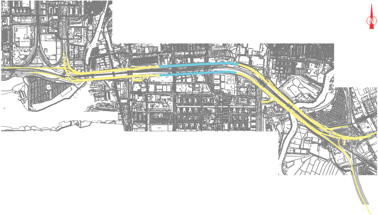
figuur 3.5 Uitbreidingen A10 op hoofdlijnen weergegeven (blauw is de tunnel, geel bovengrondse ligging)
