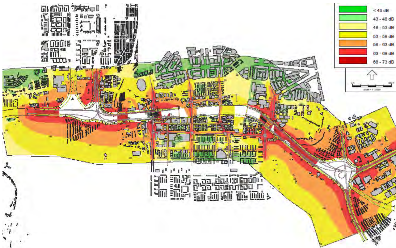
figuur 10.17 Geluidcontouren wegverkeer gecumuleerd MLT
