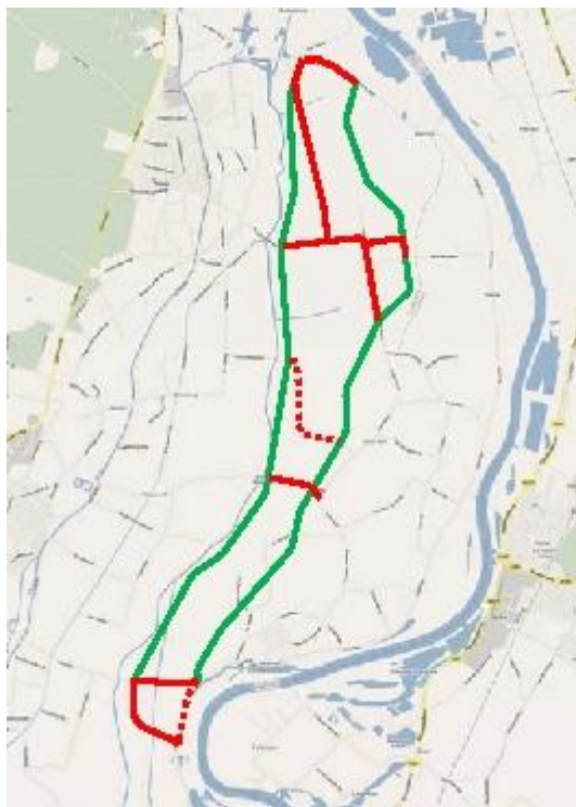
Figuur 4: Toegangs- en ontsluitingswegen door de hoogwatergeul (bron: BVA (2010)).
