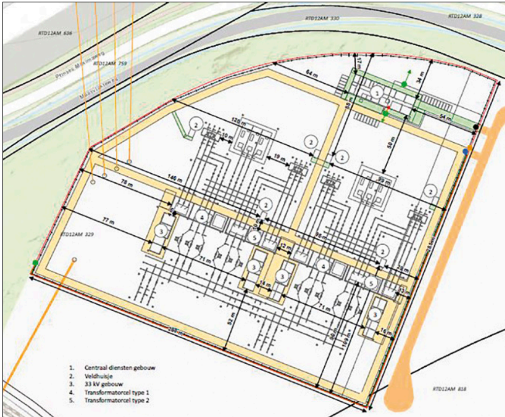
Figuur 2.6 Illustratie te realiseren transformatorstation
