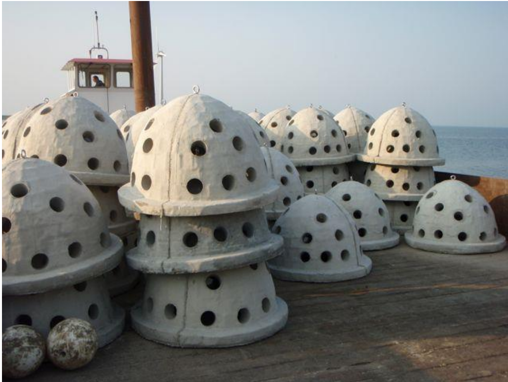
Figuur 2. Betonnen rifballen; gebruikt in het experiment Waterproeftuin Natuurlijker Markermeer en IJmeer.
