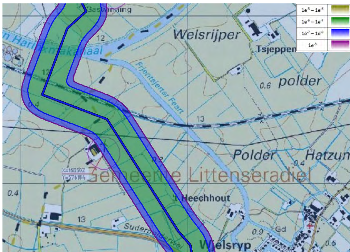
Figuur 8: PR-contouren bij een wanddikte van 7,0mm bij 90° bocht.
