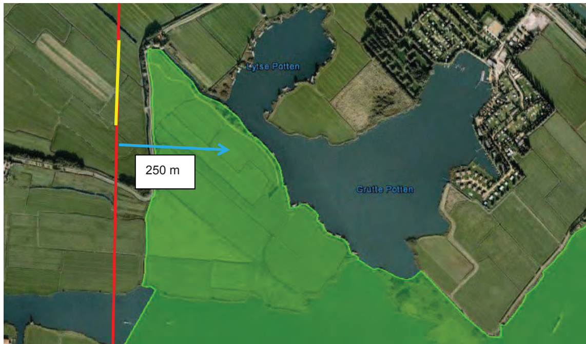
Figuur 5.2 Indicatie van het mogelijke verstoorde oppervlak. In de figuur zijn aangegeven: het Natura 2000-gebied Sneekermeergebied (groen) het tracé (rode lijn), met het deel dat wordt aangelegd middels open ontgraving (gele lijn) en een blauwe pijl, indicatief voor de verstoringssafstand (Bron: Google Earth, bewerking RHDHV).
