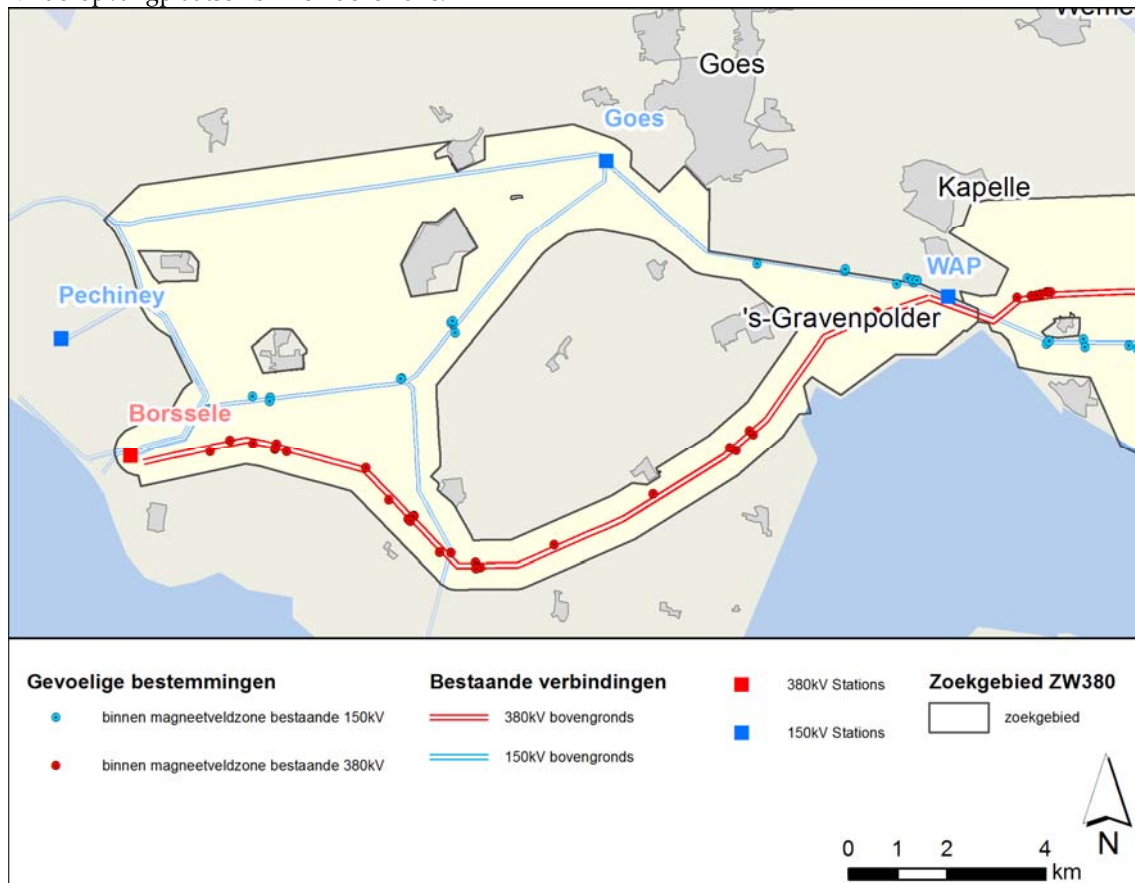
Afbeelding 42 Bestaande verbindingen binnen Deelgebied 1 en gevoelige bestemmingen binnen de magneetveldzone van deze verbindingen. Deelgebied loopt tot het 150kV-station WAP bij Kapelle (oranje streeplijn).
